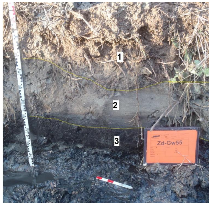
Afbeelding 8: Profiel in het midden van de westelijke sleufwand met lithologische beschrijving volgens NEN 5104/ASB
